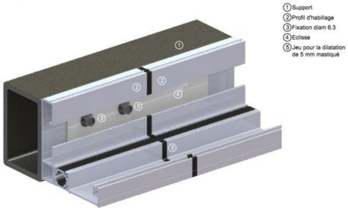
Principe d'aboutage des profils d'habillage
